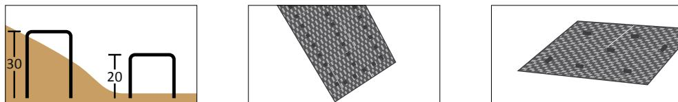
NL - Gebruik 2 haken van 30 cm per m<sup>2</sup> voor hellingen > 2:1. Gebruik 1 haak van 20 cm per m<sup>2</sup> voor vlakke oppervlakken. Of gebruik punten.
