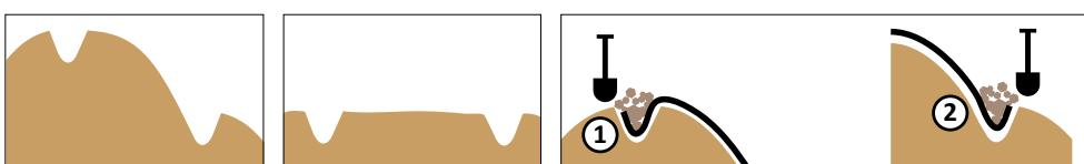
NL - Graaf een groef aan de bovenkant en aan de voet van de helling. Graaf een groef aan de zijkanten. Begin met het vullen van de groef aan de top. Trek het gronddoek recht en vul de groef aan de onderkant.
